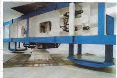
大型動的遠心力载荷試験装置
