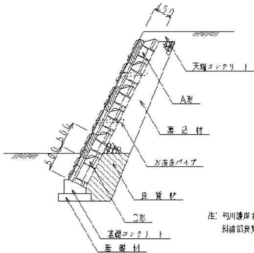
注: 河川護岸または擁壁前面に水位がある場合には、斜線部良質材を要対とします。
